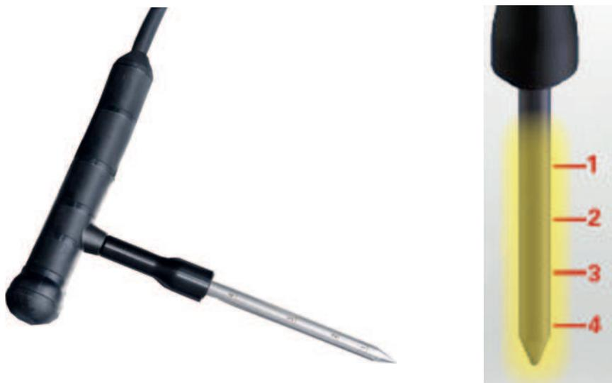
ALS Optional ist ein vorheizender Kerntemperaturfühler erhältlich. Dieser Kerntemperaturfühler verfügt über eine Heizung im Inneren, die vom jeweiligen Vorgang aktiviert wird und das Herausnehmen des Fühlers aus gefrorenen Lebensmitteln ermöglicht.
