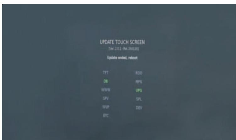
Der Vorgang endet automatisch, dann werden die korrekt installierten Dateien grün hinterlegt. Der Multifunktions-Schockfroster wird sich automatisch neu starten und anschließend den Home-Bildschirm anzeigen.
